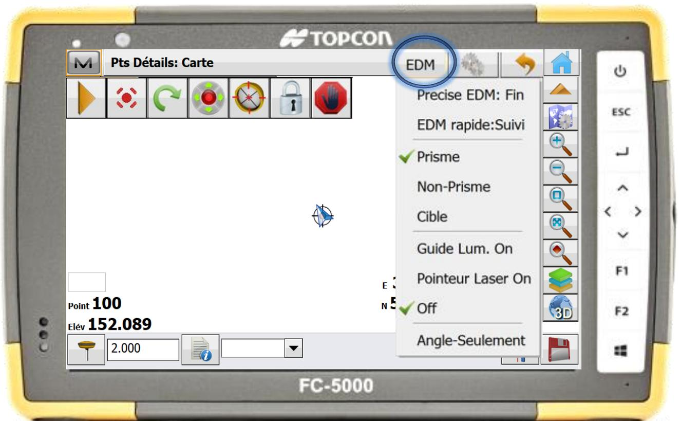
Le bouton « EDM » permet d'afficher ou non les lumières d'alignement sur la station : **Guide Lumineux On**
